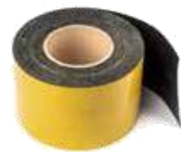
EPDM-band - Finns i valfri bredd samt som självhäftande till ställläkt icke-självhäftande till träläkt.
